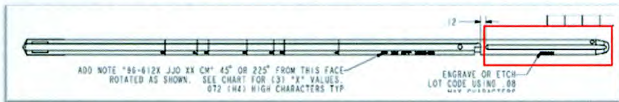
Рис. 3: Чертеж интрамедуллярного стержня (SP2 IM) с указанием области нанесения номера партии на стержне из сплава 17-4 SS .
